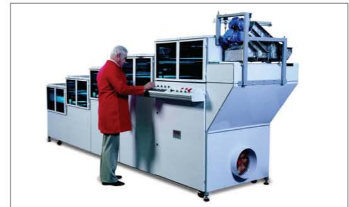
图19. 用UV对香料杀菌的设备
